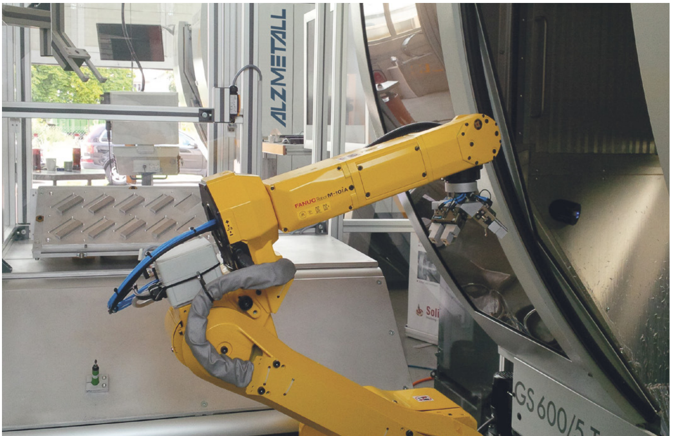
Впровадження ALZMETALL GS 600/5-T та робототехнічної комірки WU RZ-3/20 для обробки специфічних деталей. Вага переміщення 20 кг залежить від встановленого захоплювача.
