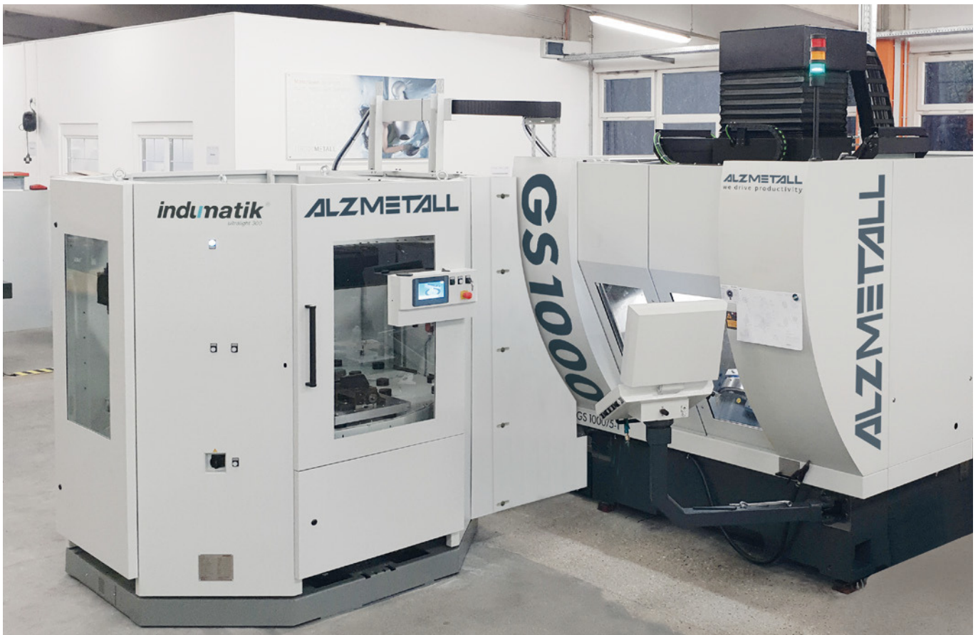
Впровадження ALZMETALL GS 1000 та INDUMATIK Ultralight 300. Вага переміщення макс. 300 кг, 3-12 позицій для палет розміром від 320 x 320 мм до 630 x 630 мм. Привід транспортера для доступу оператора.
