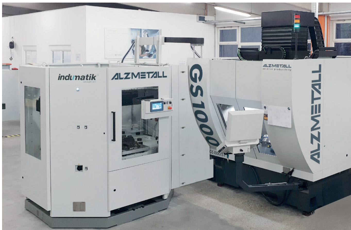
Впровадження ALZMETALL GS 1000 та INDUMATIK Ultralight 300. Вага переміщення макс. 300 кг, 3-12 позицій для палет розміром від 320 x 320 мм до 630 x 630 мм. Привід транспортера для доступу оператора.
