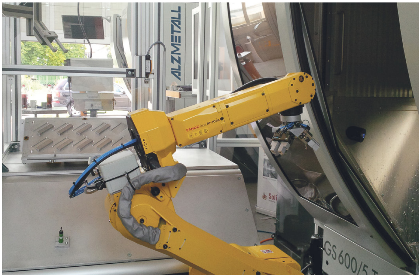
Впровадження ALZMETALL GS 600/5-T та робототехнічної комірки WU RZ-3/20 для обробки специфічних деталей. Вага переміщення 20 кг залежить від встановленого захоплювача.
