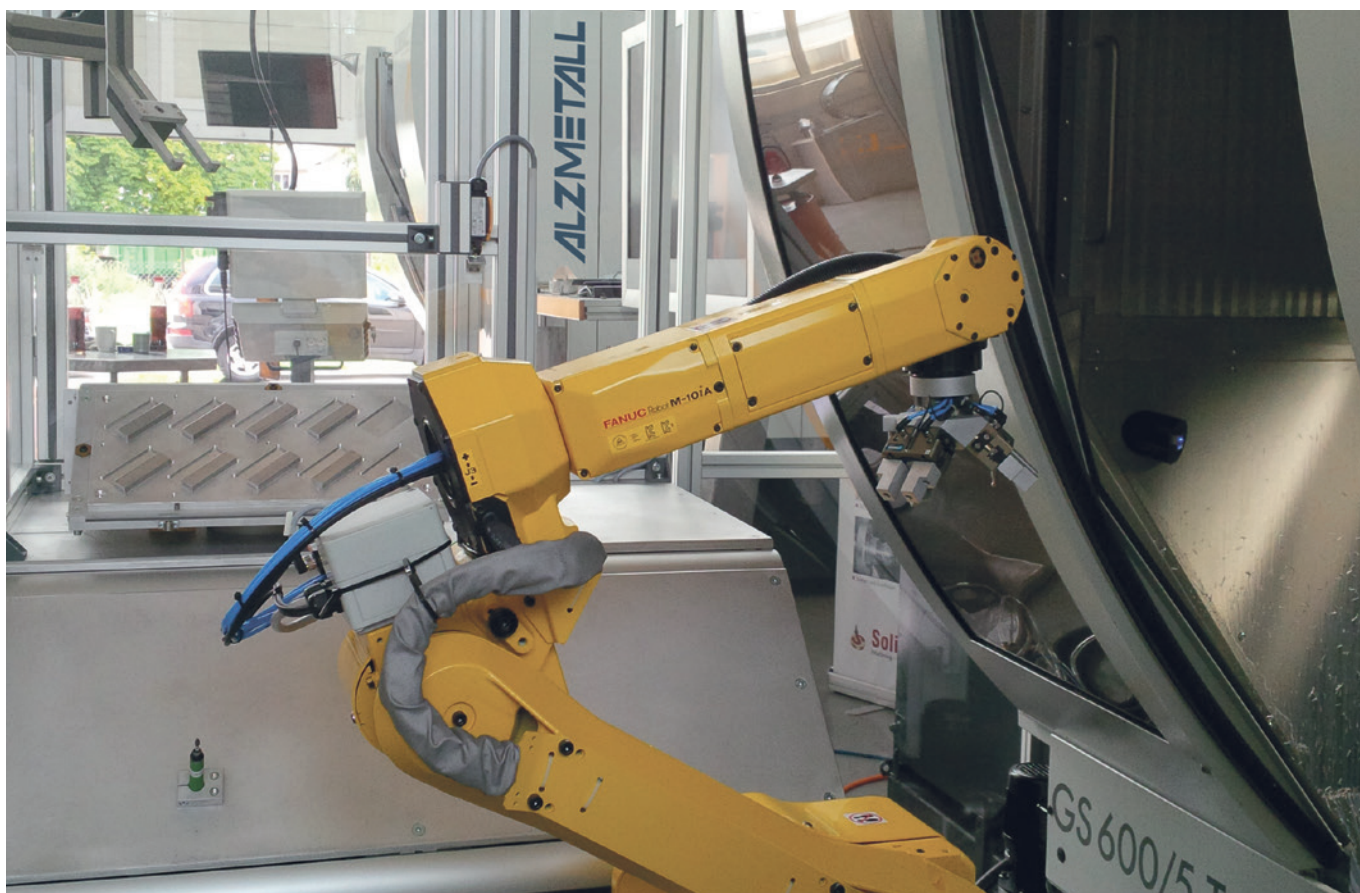
Рішення на базі ALZMETALL GS 600/5-T та роботизованої комірки WU RZ-3/20 для роботи з конкретними деталями. Маса переміщення 20 кг залежно від встановленого захоплювача.
