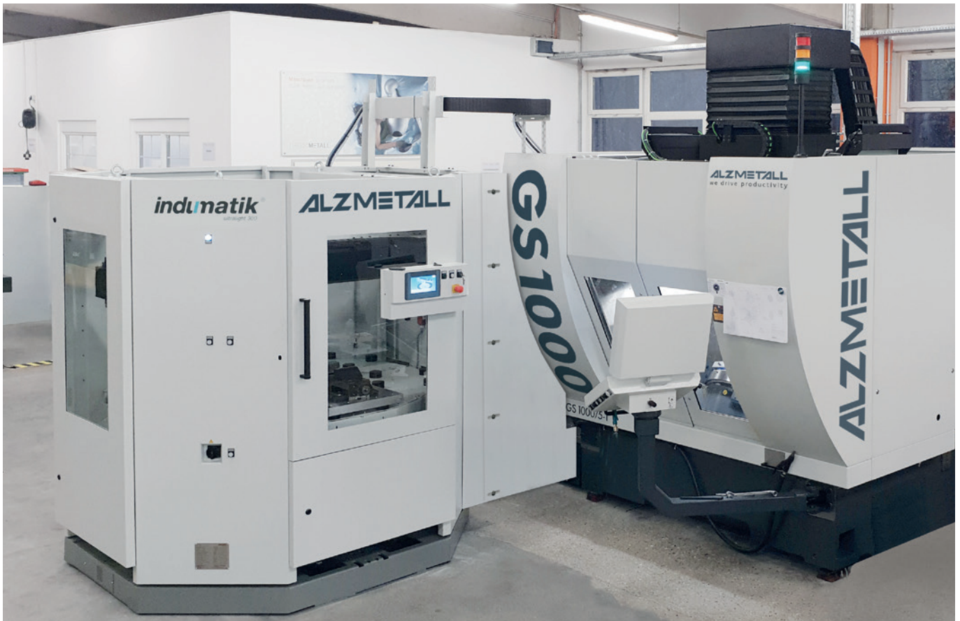
ALZMETALL GS 1000 та INDUMATIK Ultralight 300. Макс. маса переміщення 300 кг, 3–12 позицій для палет розміром від 320 × 320 мм до 630 × 630 мм. Привід транспортного носія забезпечує доступ оператора.
